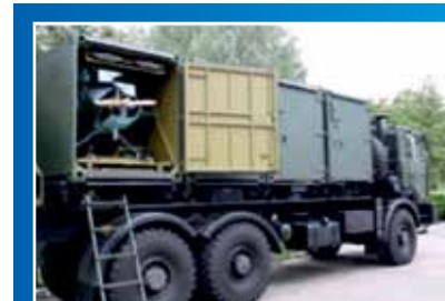
Транспортная машина ТМ. В ее составе — 4 контейнера для перевозки беспилотных летательных аппаратов
