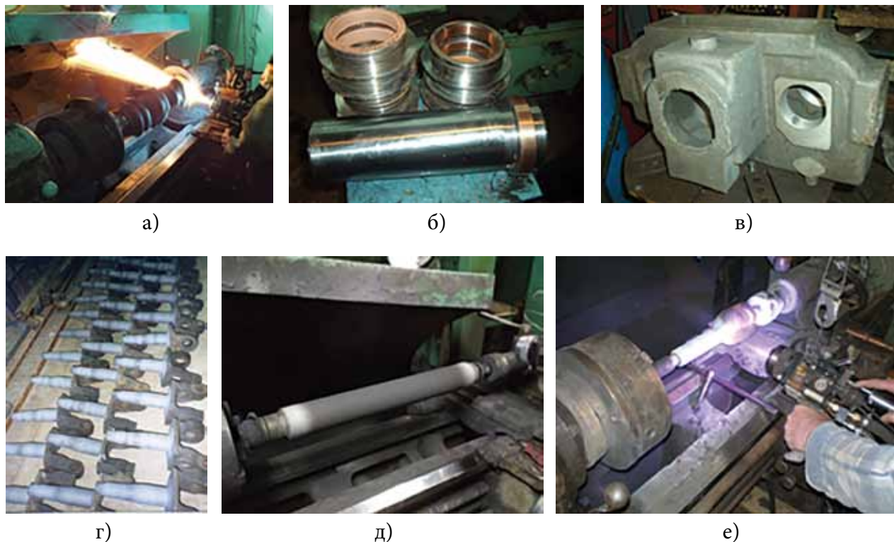
Рис. 4. Процесс нанесения покрытий (а, е) и внешний вид деталей транспорта (б, в, г, д) с покрытиями, нанесенными методом ГМ
