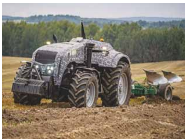
Рис. 8. Экспериментальная апробация микромодулей в разработке распределенной бортовой системы беспилотного трактора: а — структурная схема распределенной системы управления; б — внешний вид роботизированного трактора «Беларус 3521»
