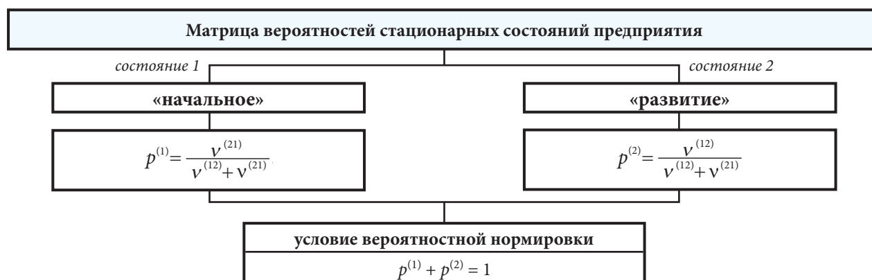
Рис. 6. Аналитические выражения для стационарных состояний предприятия
