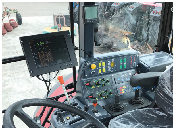
Рис. 1. Индикаторы и органы управления МТА и БК МТА НПООО «ОКБ ТСП» (слева)
