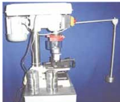
Рис. 1. Машина трения на базе сверлильного станка
