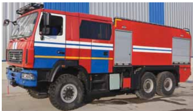
Рис. 90. Облегченная пожарная автоцистерна АЦ 8,0-40 (6302) на базе шасси МАЗ с централизованной подкачкой шин
