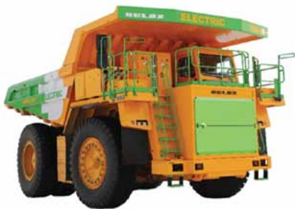
Рис. 60. Карьерный самосвал БЕЛАЗ-7558Е грузоподъемностью 90 т на аккумуляторных батареях
