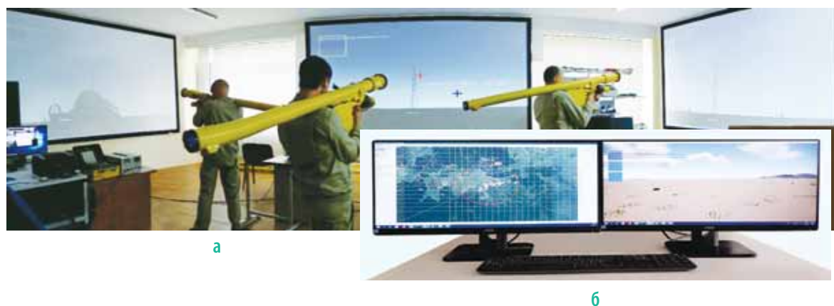
Рис. 7. Тренажер 9Ф2018 для подготовки стрелков-зенитчиков ПЗРК типа «Игла»: а — классный вариант исполнения тренажера; б — полевой вариант исполнения тренажера
