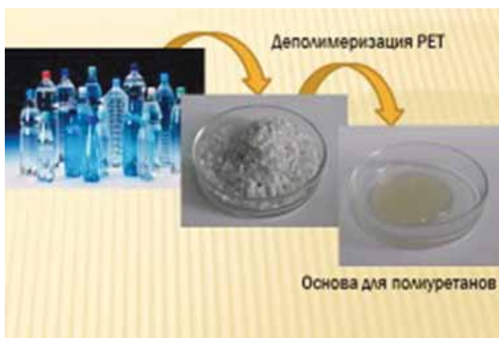
Рис. 51. Схема для получения полиолов
