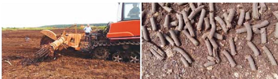
Рис. 57. Добыча торфа модернизированным комплексом торфодобывающей машины КТД-1
