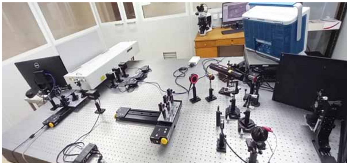
Рис. 71. Установка высокой точности для измерений порога лазерного повреждения оптических элементов
