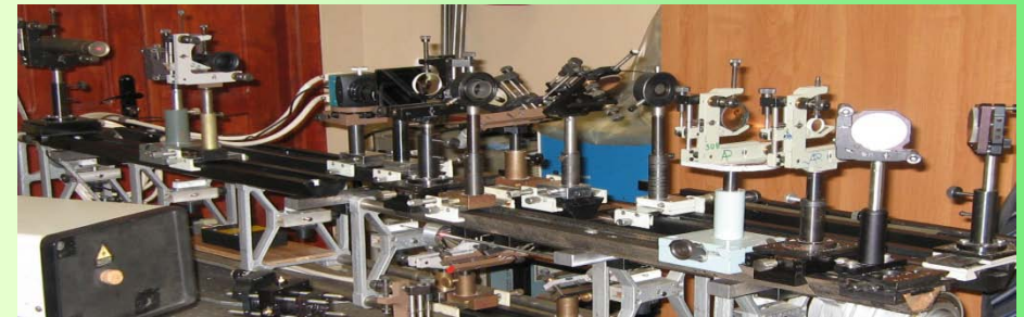
Экспериментальный образец устройства для детектирования поверхностных и приповерхностных дефектов движущейся проволоки.
