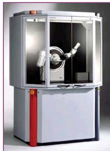
**Назначение:** проведение рентгеноструктурного анализа, определение фазового состава материалов, определение макронапряжений в поверхностных слоях.
