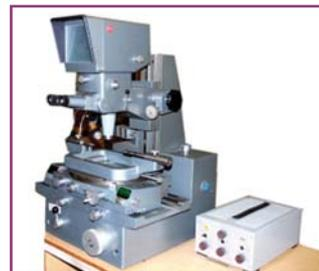
**Измерительная система для измерения плоскостности, прямолинейности «Вилер — Левель — Компьютер»**
