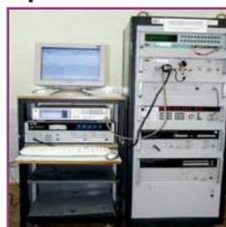
**Назначение:** воспроизведение, хранение и передача единицы напряжения переменного тока; исследования в области измерения/воспроизведения напряжения переменного тока.
