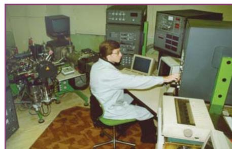
**Электронный Оже-спектрометр РН-660**
