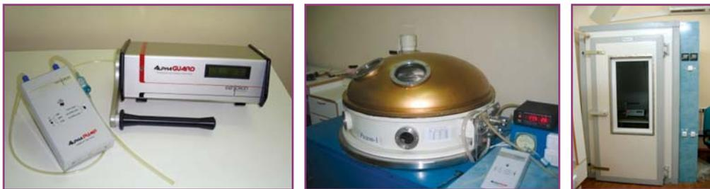
**Назначение:** проведение высокоточных измерений объемной активности радона-222 в воздухе.
