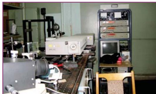
**Установка ионного утонения, полировки, очистки PECS 682**
