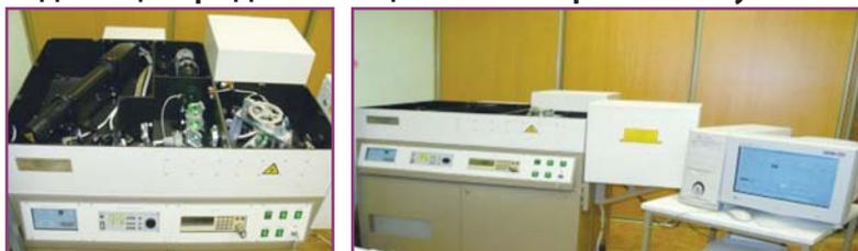
**Назначение:** хранение, воспроизведение и передача единицы средней мощности лазерного излучения в диапазоне от 50 до 1300 мВт на длинах волн 0,532 и 10,6 мкм, поверка, калибровка СИ.
