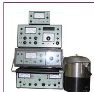
**Комплект оборудования для испытаний технических средств на электробезопасность**
