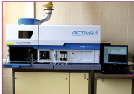
**Назначение:** определение элементного состава материалов с пределом обнаружения  $10^{-4}$ ,  $10^{-5}$ .
