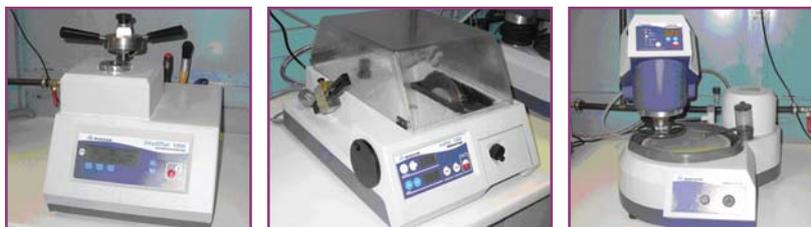
**Назначение:** изготовление прецизионных микрошлифов, сколов кристаллов субмикронных ИМС и их микросборок с использованием металлографической резки, шлифовки.
