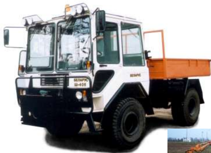
“Беларус” Ш-406 Двигатель Д-245.2S2 мощностью 90 кВт (120 л.с.)
