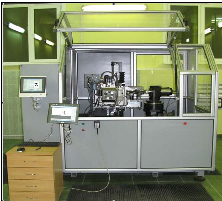
Установка для магнитореологического финишного полирования оптических изделий (ИТМО НАН Беларуси)
