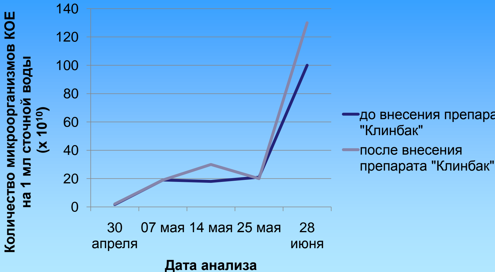
Рис. 1 – Количество микроорганизмов активного ила в рециркуляционной камере (рост на МСА)
