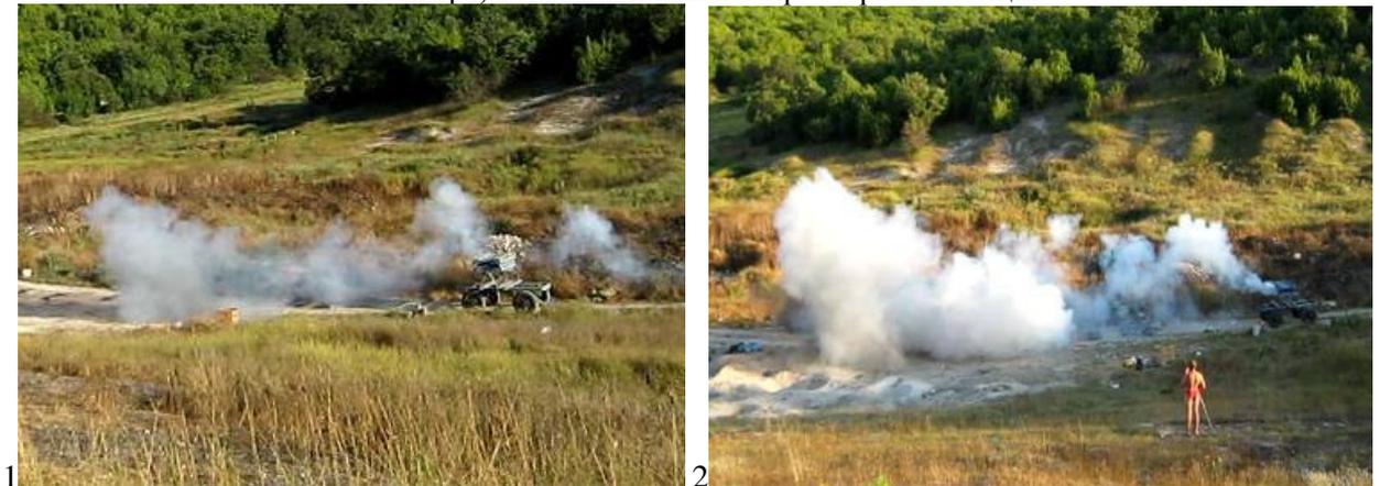
Рисунок 4. 1- фрагмент импульсного распыления 2кг сорбента из одного ствола, 2- фрагмент залпового распыления 10кг сорбентов из 5-ти стволов.
