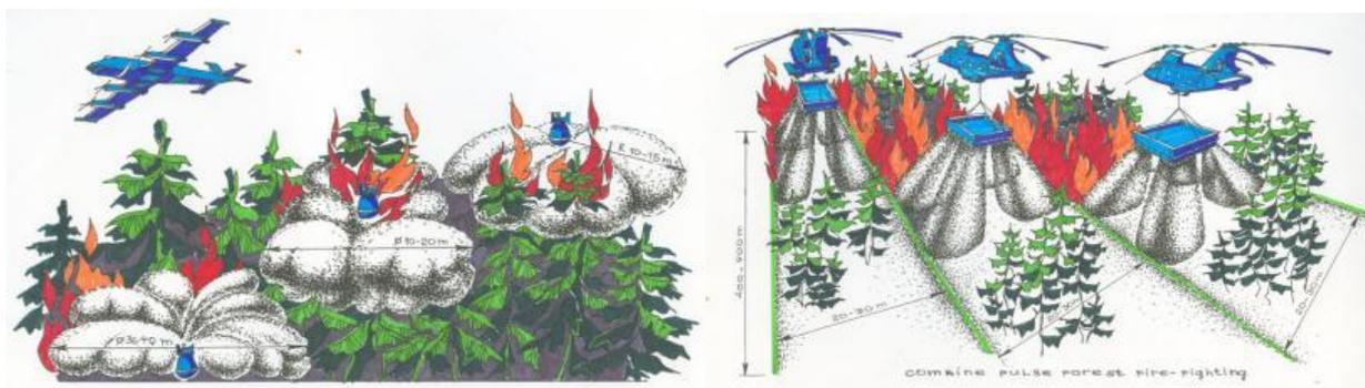
Рисунок 3. 1-я и 2-я стадии тушения лесного пожара: прицельное бомбометание фронта лесного пожара и ковровое, квадратно-гнездовое распыления по горящему лесу.
