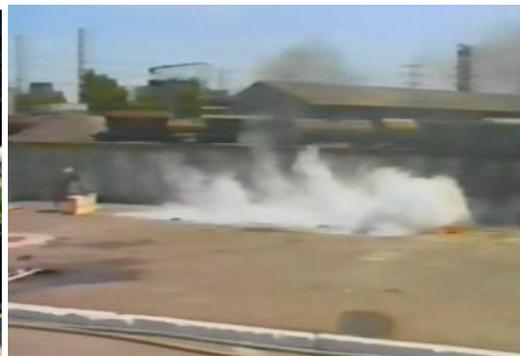
Рисунок 4. Распыление 1,5 кг мокрого песка на 25 м по горизонтали и до 14 м в высоту под углом до 75°. Рисунок 5. Тушение 20 м<sup>2</sup> двумя кг порошка при дальности до 12 м и ширине 1-3 м.
