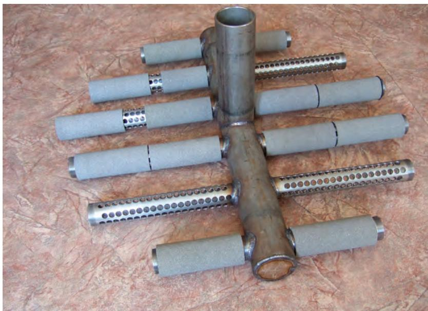
Рис. 3. Фильтроэлементы из ППМ и фрагмент ДРУ
