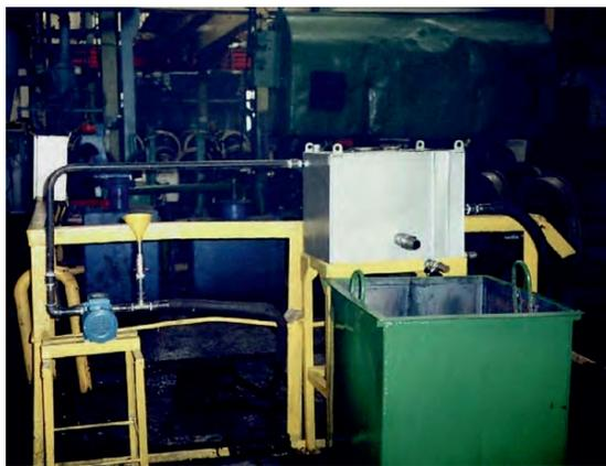
Фото 1. Установка «Флотатор-У» производительностью до 2 м<sup>2</sup>/час на моечной машине.
