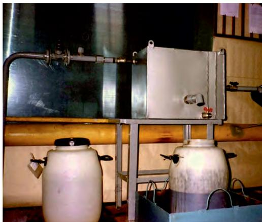
Фото 2. Установка «Флотатор-У» подключенная к системе очистного сооружения.
