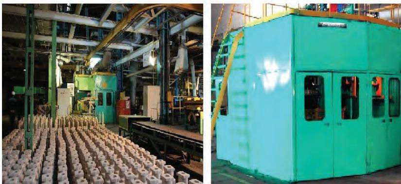
Рис. 3. Внешний вид стержневой машины модели 4747
