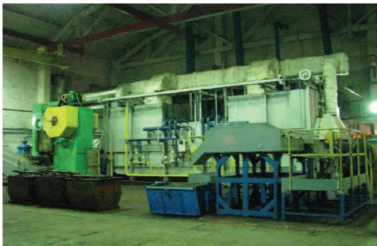
Рис. 4. Линия горячего брикетирования в цехе заготовки шихты
