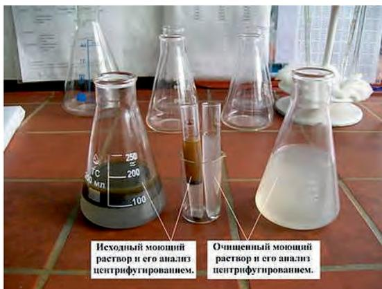
Фото 3. Эффективность очистки горячего моющего раствора при пропускании его через установку «Флотатор-У».
