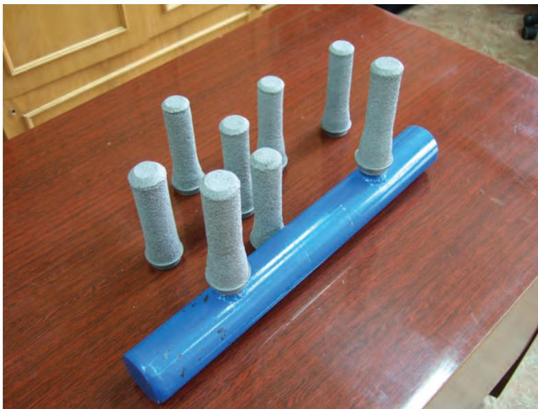
Рис. 4. Фильтроэлементы из КПМ и фрагмент ДРУ
