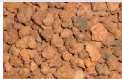
Рис. 2. Керамзит, полученный с использованием шламов гальванического производства
