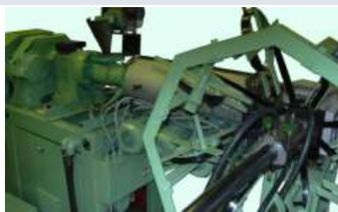
Линия на базе универсальной пултрузионной установки для получения стеклоармированных профилей с гибридной структурой на основе термопластов
