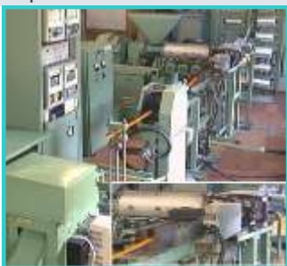
Линия на базе универсальной пултрузионной установки для получения профильных изделий из армированных термопластов
