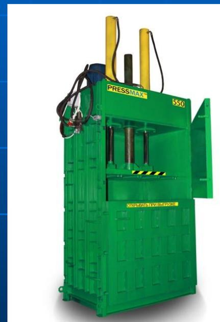
*Для оборудования станций приобретаются вертикальные прессы с усилием 50 тонн, перфораторы для прорезания ПЭТ-бутылок, линии для ручного разделения ВМР*
