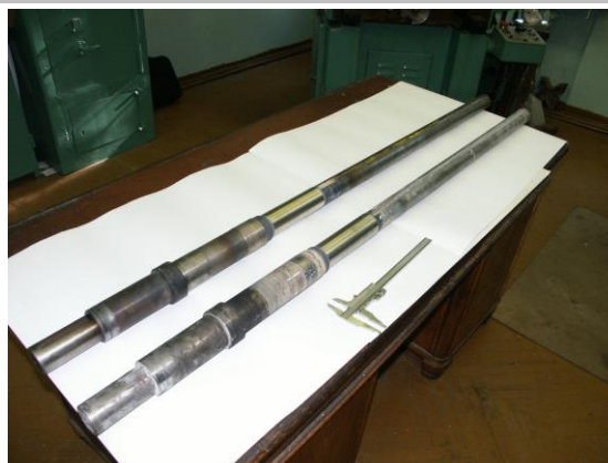
Восстановленные валы (а) и шнеки насосов (б)
