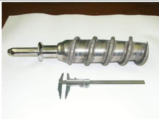
Восстановленные валы (а) и шнеки насосов (б)
