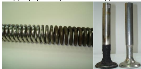
Внешний вид образцов после электроимпульсного полирования
