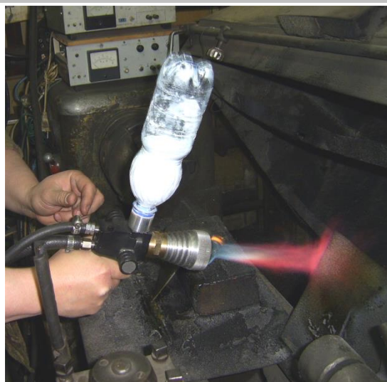
Процесс газопламенного напыления полимерного покрытия
