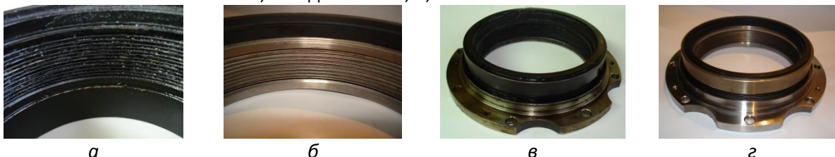
Внешний вид торцовых уплотнений до и после очистки
