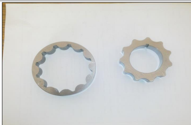
Экспериментальные образцы порошковых деталей «Ротор ведомый» и «Ротор ведущий»
