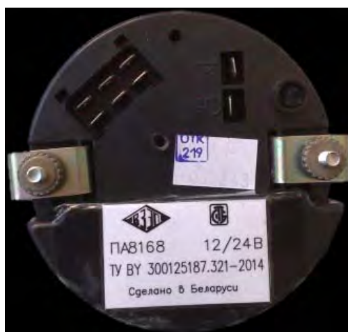
Указатель скорости ПА8168 (вид сзади)
