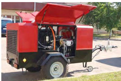
Вид ПССВ 4/7-50 со стороны насоса для пенообразователя
