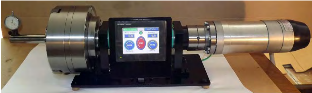
Демонстрационный стенд работы зажимного самоцентрирующегося патрона ОАО «БелТАПАЗ»
