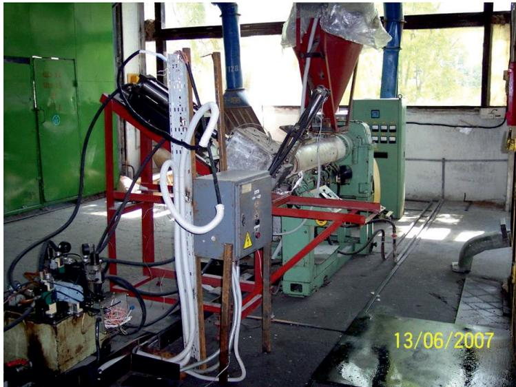
Рисунок 1 – Промышленная установка ОАО «ОЗАА» по методу прессования предварительно пластицированных термопластичных композиций
