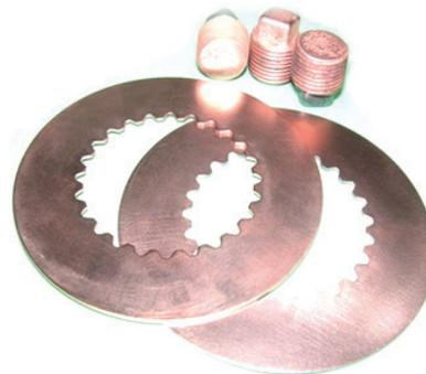
Рисунок – Диски сцепления и чугунные пробки с электроосажденным функциональным медным покрытием
