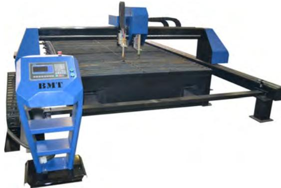
**Аппарат воздушно-плазменной резки «Оливер» ВПР-70/-80/-100/-120**
