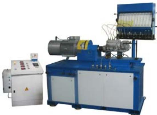
**Стенд для испытания и регулировки топливных насосов высокого давления для локомотивных дизелей**
