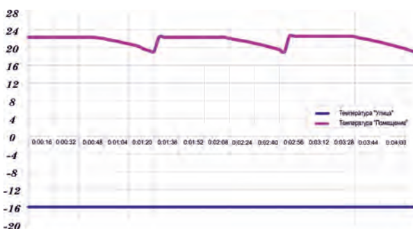
Диаграмма изменения температуры приточного воздуха со стороны помещения при работе прибора "Паветрик". Синяя линия – наружная температура. наружной температуры.
