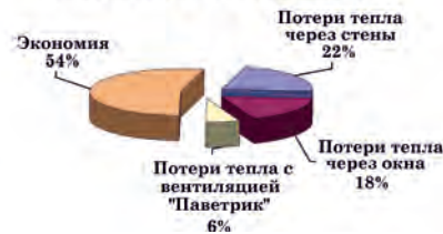
Структура тепловых потерь в жилом доме оборудованном вентиляцией "Паветрик", и экономия тепла по сравнению с естественной вентиляцией
