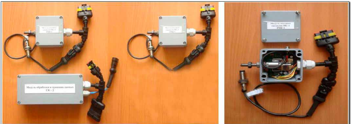
Модули системы автоматизированного вибромониторинга трансмиссионных узлов мобильных машин
