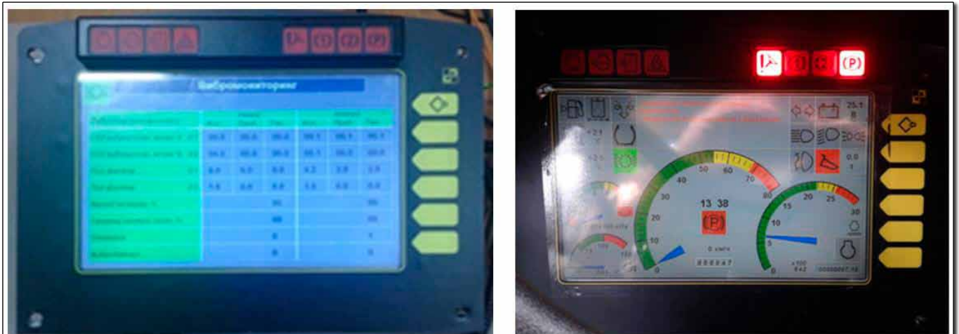
Представление информации системы автоматизированного вибромониторинга трансмиссионных узлов мобильных машин на панели самосвала БЕЛАЗ
