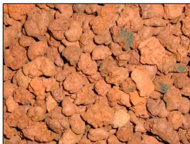
Керамзит, полученный с использованием шламов гальванического производства
