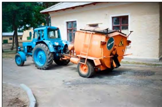
Мобильный агрегат для приготовления горячей асфальтовой смеси РДЖ-2,8 (ОАО «Бобруйскагромаш»)
