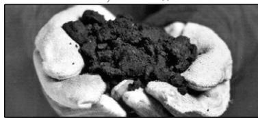
Порошок из кровельных битумных отходов
