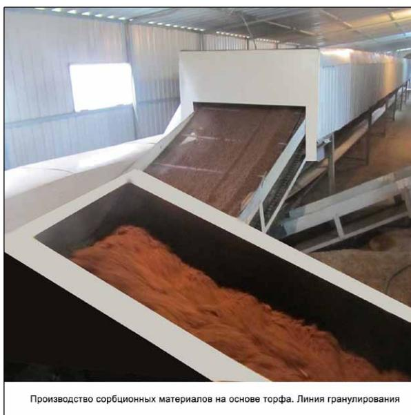
Производство сорбционных материалов на основе торфа. Линия гранулирования.
