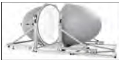
Фотометрические шары диаметром 1,00 м и диаметром 2,00 м
