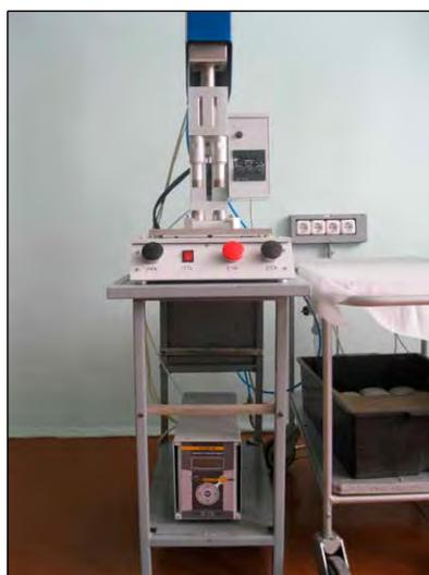
Установка для ультразвуковой сварки сит с картриджем
