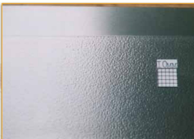
Поверхность после пневмовибродинамической обработки
