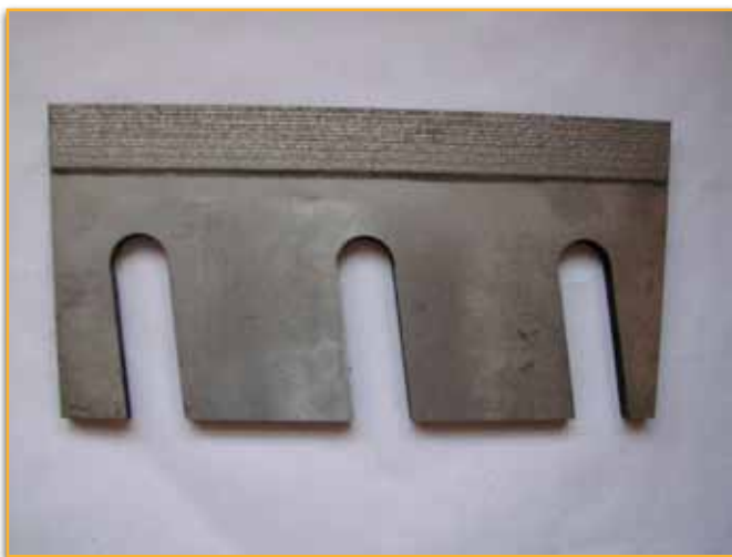
Нож измельчителя кормоуборочного комбайна КВК-800, упрочненный методом лазерной обработки
