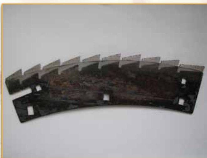
Нож кукурузной жатки «CLAAS», упрочненный методом лазерного модифицирования
