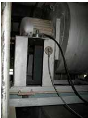
Исследование вибрационного состояния двигателя вентиляционной системы
