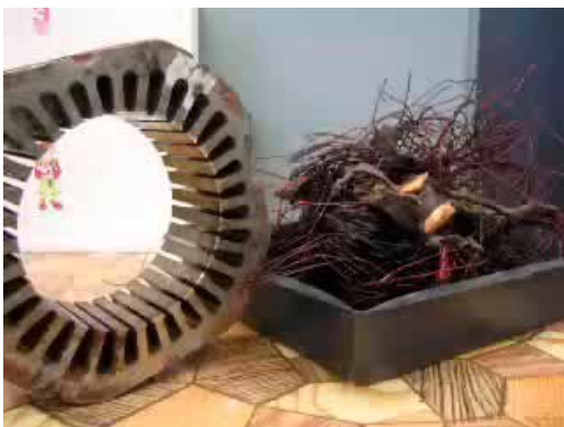
Разобранный статор с извлеченными обмотками
