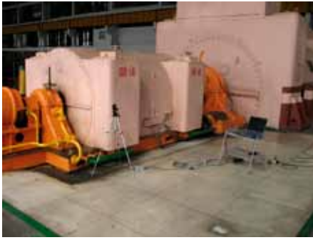
Применение виброизмерительного комплекса при обследовании турбоагрегата
