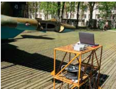
Исследование вибрационного состояния конструктивных узлов самолета
