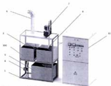
Рисунок 1 – Общий вид установки ЭПП-15. 1 – рама; 2 – рычаг жима; 3 – ванна охлаждения и размораживания с ней индукцией; 4, 5 – ванна с раствором электролита; 6 – дорезушный насос; 7 – ледяной насос; 8 – ручка привода поворотного стола; 9 – корпус системы малярной вентиляции; 10 – шланговый насос; 11 – шароподъемный
