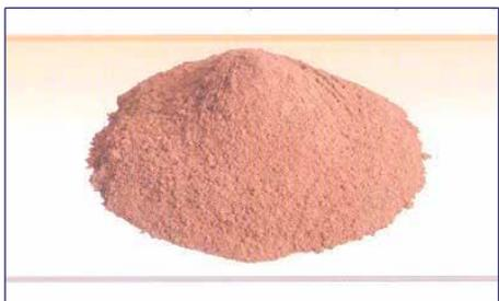
Связующий мертель для кладки низкотемпературных теплогенерирующих устройств
