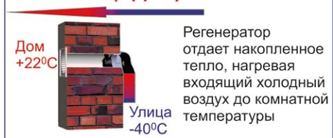
Регенератор отдает накопленное тепло, нагревая входящий холодный воздух до комнатной температуры
