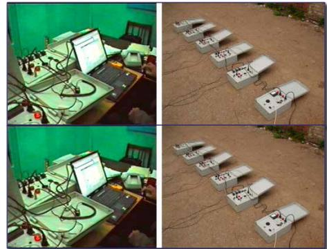
Дистанционная система микропроцессорного управления взрывом
