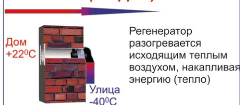
Регенератор разогревается исходящим теплым воздухом, накапливая энергию (тепло)
