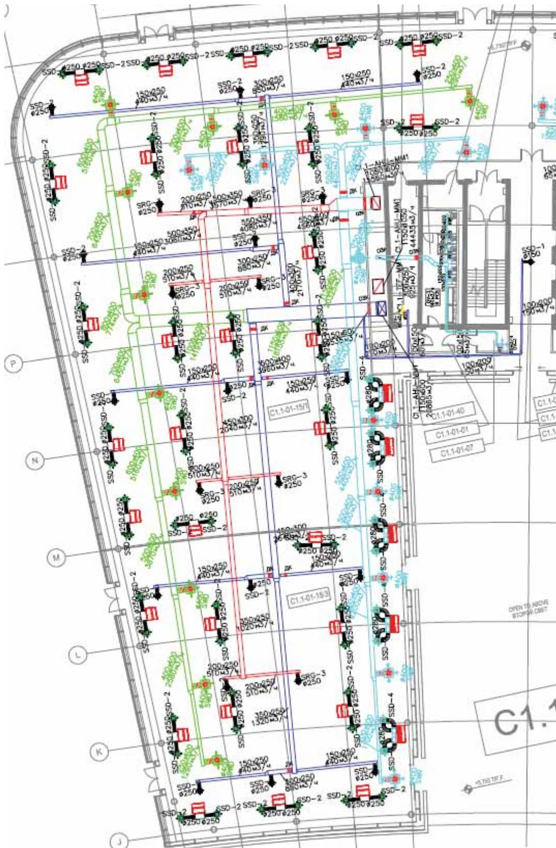
Рисунок 24 Примерный план расположения каналов приточно-вытяжной вентиляции на Объекте в Павильонах Официальных участников.
