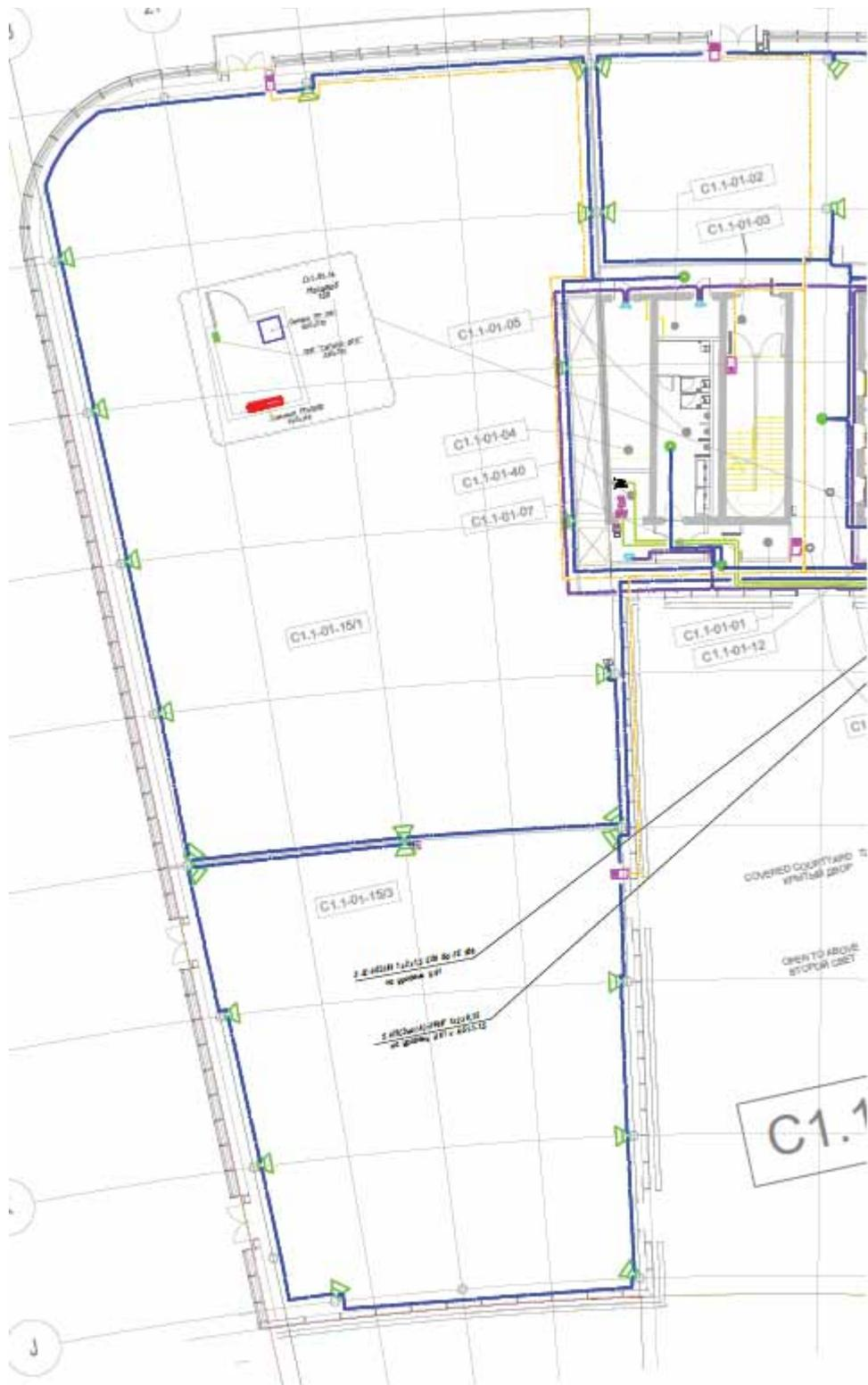
Рисунок 19. Примерный план расположения приборов системы оповещения в Павильонах Официального участника на 1 этаже Объекта.
