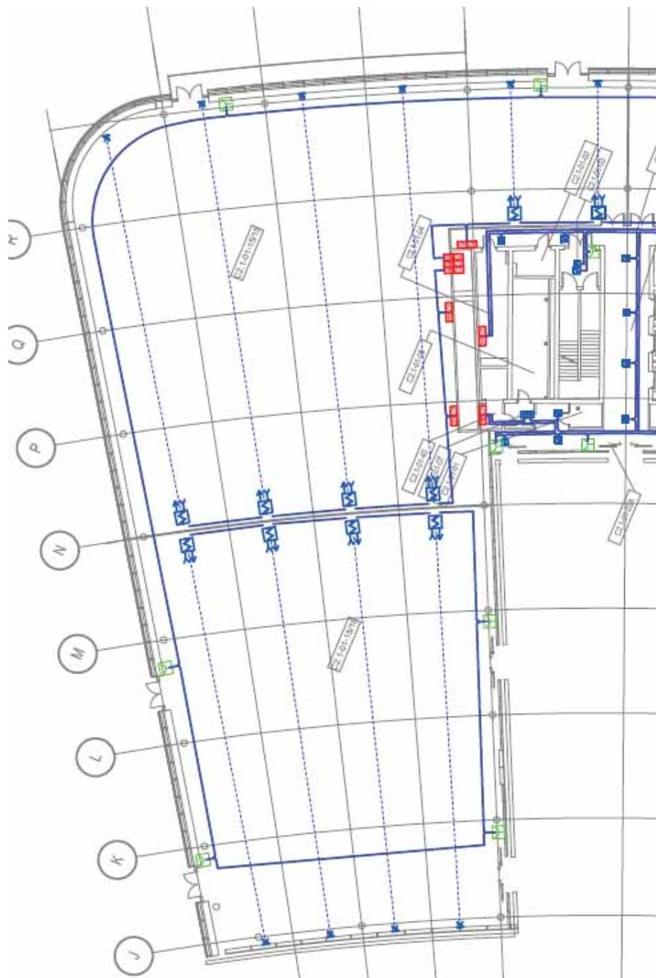
Рисунок 18. Примерный план расположения датчиков автоматической пожарной сигнализации в Павильоне Официального участника на 1 этаже Объекта.
