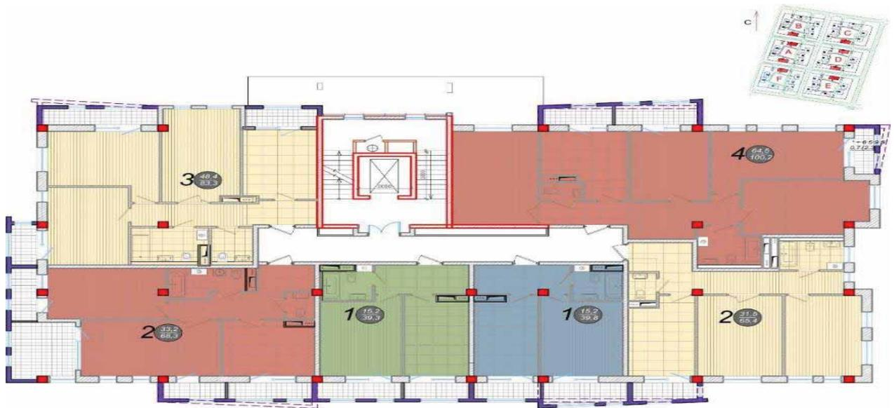
Рис.: План типового этажа жилого здания ЭКСПО-городка. Тип 1
