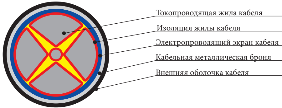
Рис. 4. Кабель с четырьмя основными секторными жилами и одной нулевой жилой круглого сечения
