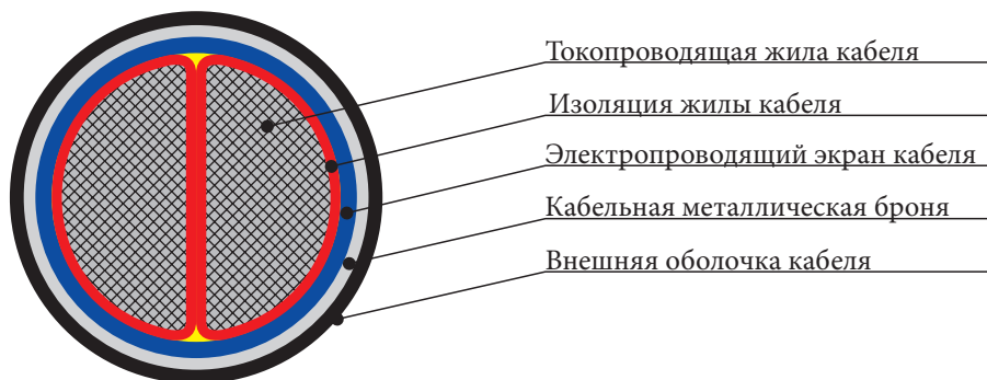
Рис. 5. Кабель с двумя сегментными жилами
