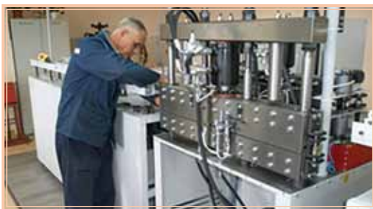
ШТАМП № 2 (ОПЫТНЫЙ ОБРАЗЕЦ). ПЕРЕПРОФИЛИРОВАННАЯ ТЕПЛООБМЕННАЯ ТРУБА
