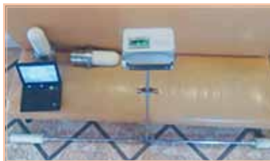
ПОШУКАВАЯ СІСТЭМА ДЛЯ ЎНУТРЫТРУБНЫХ ТЭХНАЛАГІЧНЫХ ПРЫЛАД НАФТАПРАВODА
