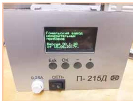
**ОПЫТНЫЙ ОБРАЗЕЦ ПРЕОБРАЗОВАТЕЛЯ ПРОМЫШЛЕННОГО ДВУХКАНАЛЬНОГО П-215Д**
