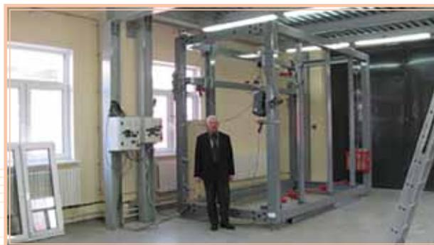
Конструкция стенда — разборно-сборная. В разобранном состоянии все детали проходят через стандартный дверной проём. Количество персонала, необходимое для проведения испытаний — 1 человек.
