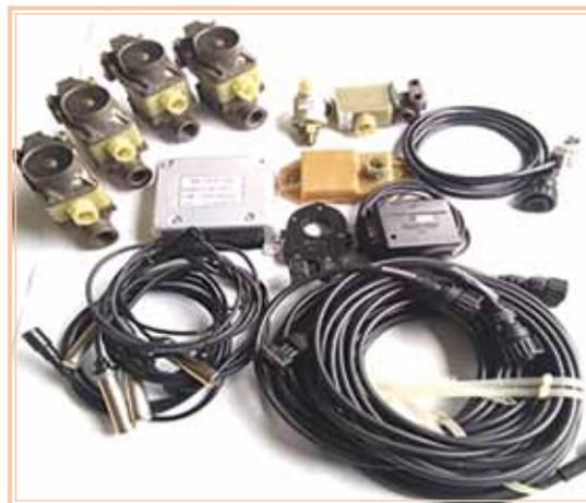
Обеспечение электронного управления элементами тормозной системы, управление давлением в тормозных механизмах, контроль продольного и поперечного ускорения транспортного средства.
