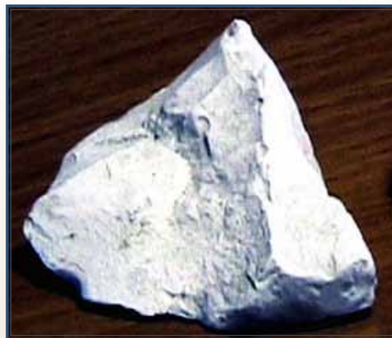
ИСКУССТВЕННЫЙ ГИПСОВЫЙ КАМЕНЬ НА ОСНОВЕ ФОСФОПОЛУГИДРАТА — ОТХОДА ПРОИЗВОДСТВА ЭКСТРАКЦИОННОЙ ФОСФОРНОЙ КИСЛОТЫ ПОЛУГИДРАТНЫМ СПОСОБОМ
