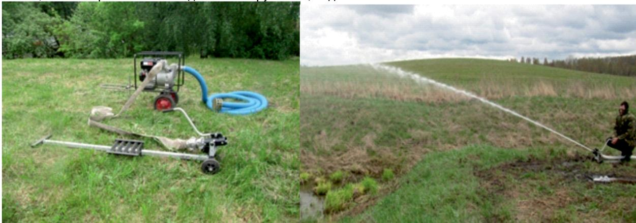
**Струя воды, исходящая из насадка гидромонитора установки УПТ-75**
