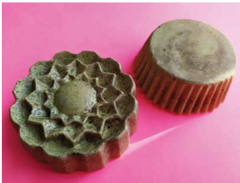
Образцы из серного бетона
