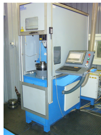
УСТАНОВКА ЛАЗЕРНОГО ТЕРМОУПРОЧНЕНИЯ МАЛОГАБАРИТНЫХ ДЕТАЛЕЙ ОАО «БЕЛАЗ»
