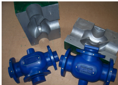
МОДЕЛЬ КОРПУСА СО СТЕРЖНЕВЫМ ЯЩИКОМ
