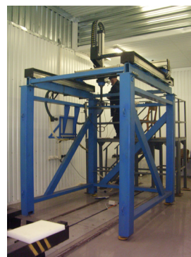
УСТАНОВКА ЛАЗЕРНОГО ТЕРМОУПРОЧНЕНИЯ КРУПНОГАБАРИТНЫХ ДЕТАЛЕЙ ОАО «БЕЛАЗ»
