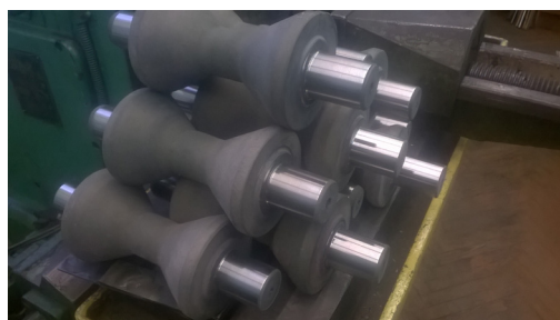
РОЛИКИ ДЛЯ ВОЛОЧЕНИЯ ПРОВОЛОКИ, УПРОЧНЕННЫЕ ГАЗОПЛАМЕННОМ НАПЫЛЕНИЕМ
