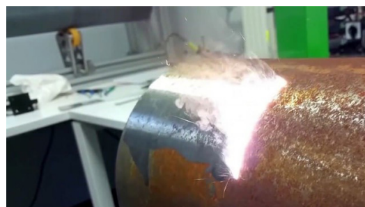
ПРОЦЕСС ЛАЗЕРНОЙ ОЧИСТКИ ПОВЕРХНОСТИ ТРУБЫ ОТ РЖАВЧИНЫ
