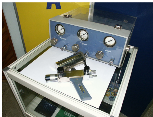
УСТАНОВКА ГАЗОПЛАМЕННОГО НАПЫЛЕНИЯ ТРУ-2.1Р
