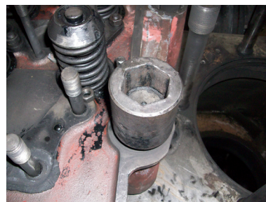
РЕЗЬБОВЫЕ СОЕДИНЕНИЯ, КРЕПЯЩИЕ ГОЛОВКИ ЦИЛИНДРОВ ДИЗЕЛЬНЫХ ДВИГАТЕЛЕЙ ТЕПЛОВЗОВ ЧМЭ-3
