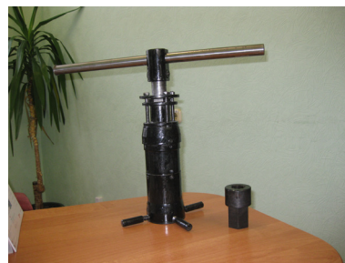
БАЛЛОННЫЙ КЛЮЧ С ПРОМЕЖУТОЧНЫМИ ТЕЛАМИ КАЧЕНИЯ
