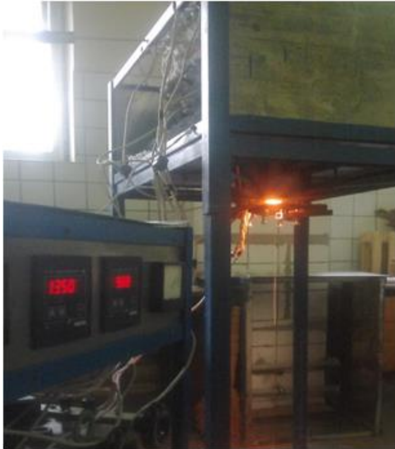
1 – блок управления; 2 – трансформаторы; 3 – печь; 4 – загрузочное отверстие; 5 – плавильная ванна с узлом слива расплава; 6 – волокно; 7 – наматывающее устройство
