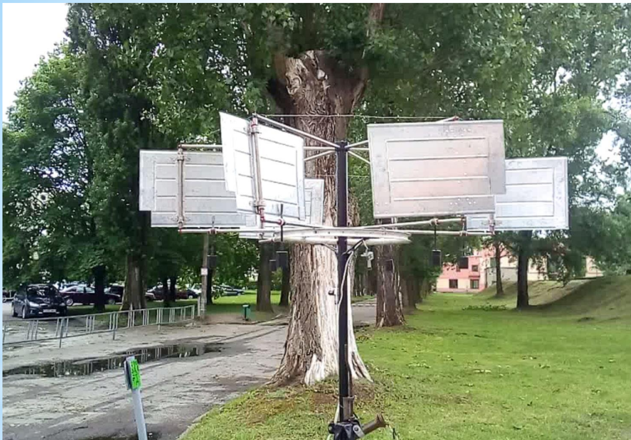
Макет усовершенствованной конструкции ветроустановки с дополнительными лопастями
