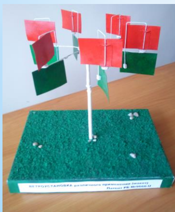
Макет усовершенствованной конструкции ветроустановки с дополнительными лопастями
