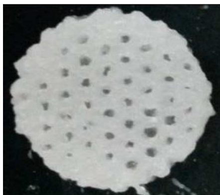
Трехмерный образец, напечатанный с использованием композита на основе ПЛА и ГА
