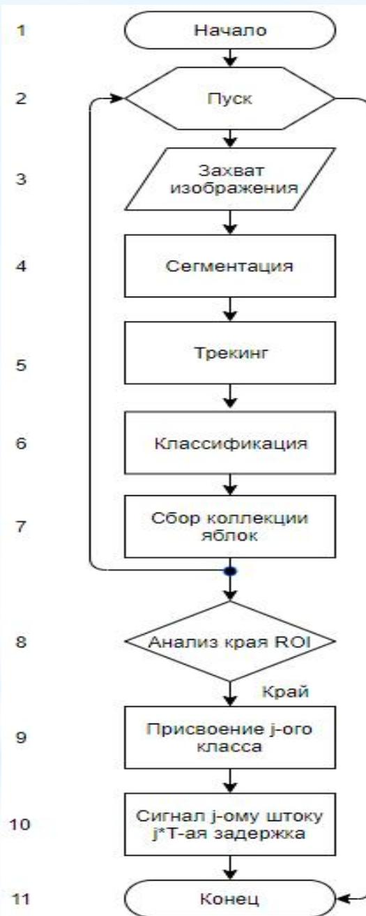
Алгоритм функционирования ПО установки автоматической сортировки яблок с помощью СТЗ
