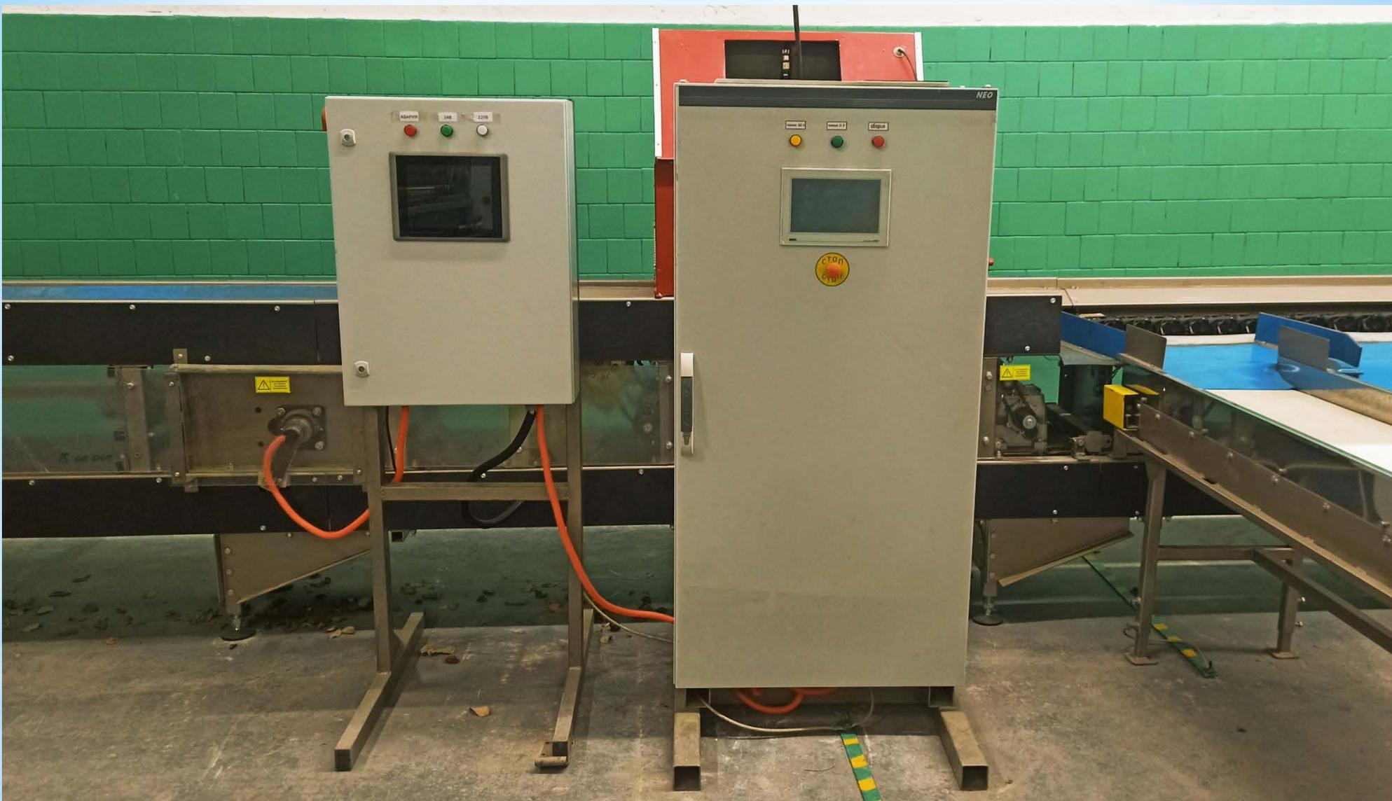
Шкаф управления модулем оптической сортировки плодов
