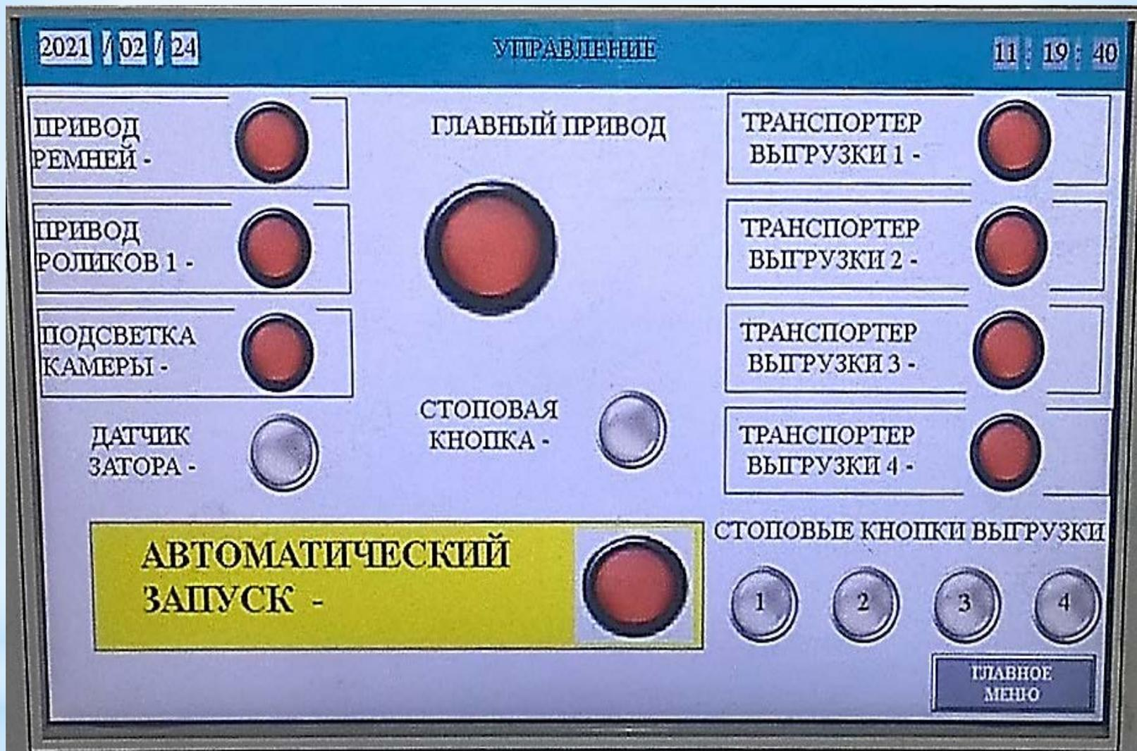
Графическая панель управления сортирующей частью линии
