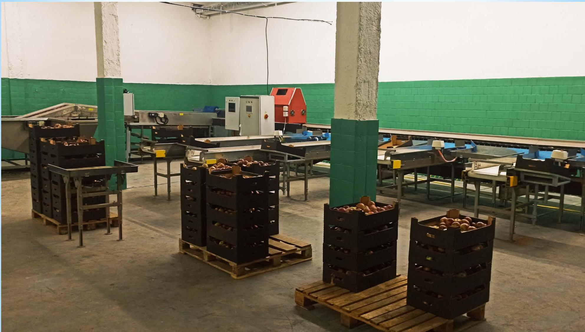
Опытный образец технологической линии сортировки и фасовки яблок ЛСП-4 в сборе
