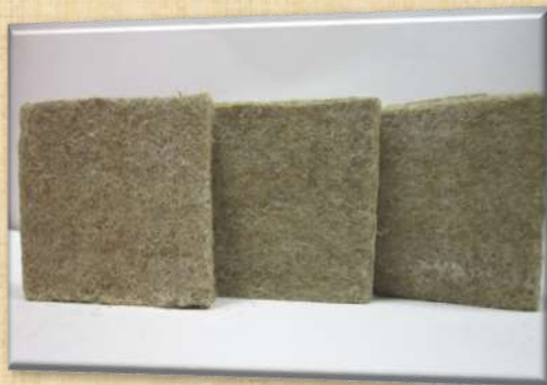
Теплоизоляционный материал на основе очесов волокна льна (Беларусь)
