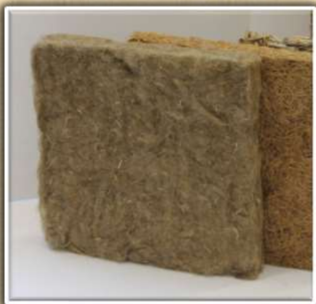
Теплоизоляционный материал на основе очесов волокна льна (Беларусь)
