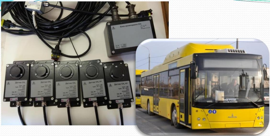
Система предназначена для мониторинга CH<sub>4</sub> в критических точках транспортных средств – моторном отсеке, в местах установки газовых баллонов, отсеке предпусковых жидкостных подогревателей двигателя, у редукторов газовых баллонов и др.
