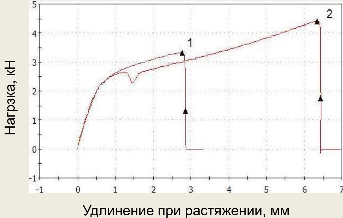
Рис. 2. Испытания на условный сдвиг композиционных соединений
