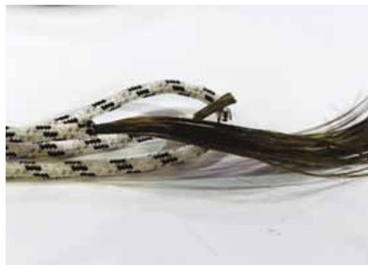
Общий вид шнура с наполнителем: а — базальтовый, б — полиэстеровый с базальтовым наполнителем
