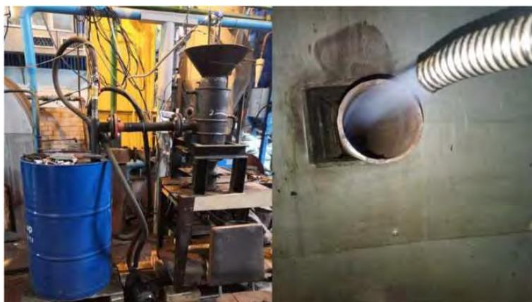
Общий вид газогенераторной установки и выход генераторного газа
