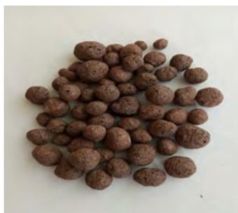
*Теплоизоляционный пористый заполнитель*
