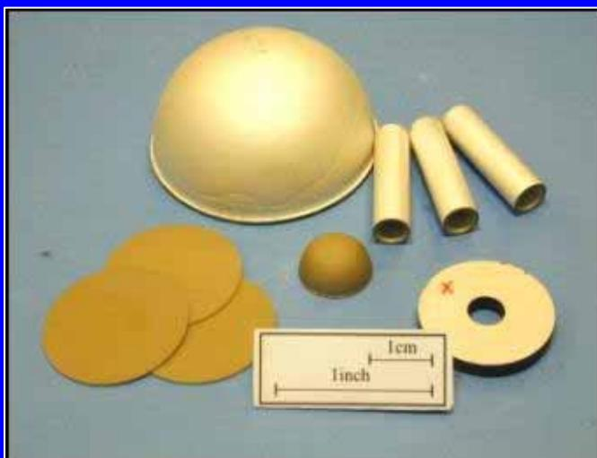
Пьезокерамические излучатели и приемники предназначены для использования в составе ультразвуковых расходомеров жидкости и теплосчетчиков. Рабочие частоты – (200...3000) кГц, диаметр – (10 ... 50) мм. Уход рабочей частоты в интервале температур (5...150)<sup>0</sup>С не более 0,5 %. поставлялись для предприятий: МПО "Вычислительной техники", НИИ ПФП БГУ, ПУП «Белсимет», завод «Измеритель» г. Новополоцк, завод «Кобальт» г. Плещеницы.
