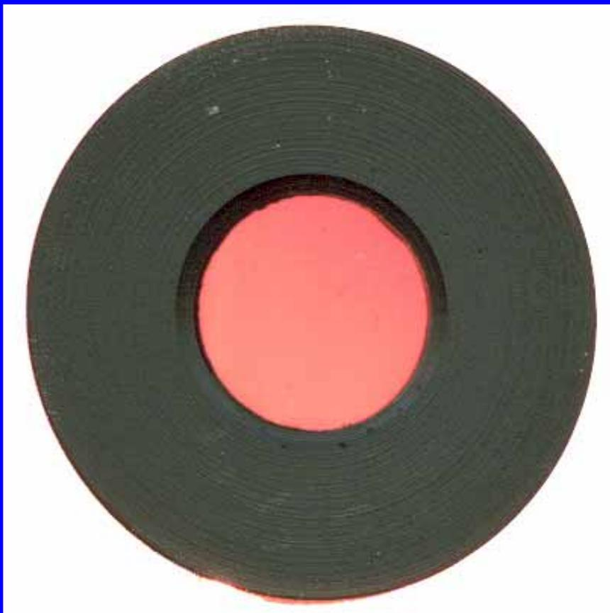
Используя  $\text{CdP}_2$ , как нелинейный оптический элемент изготовлены элементы (совместно в ИФ НАН Украины) для управления длительностью импульсов генерации рубинового и неодимового лазеров.
