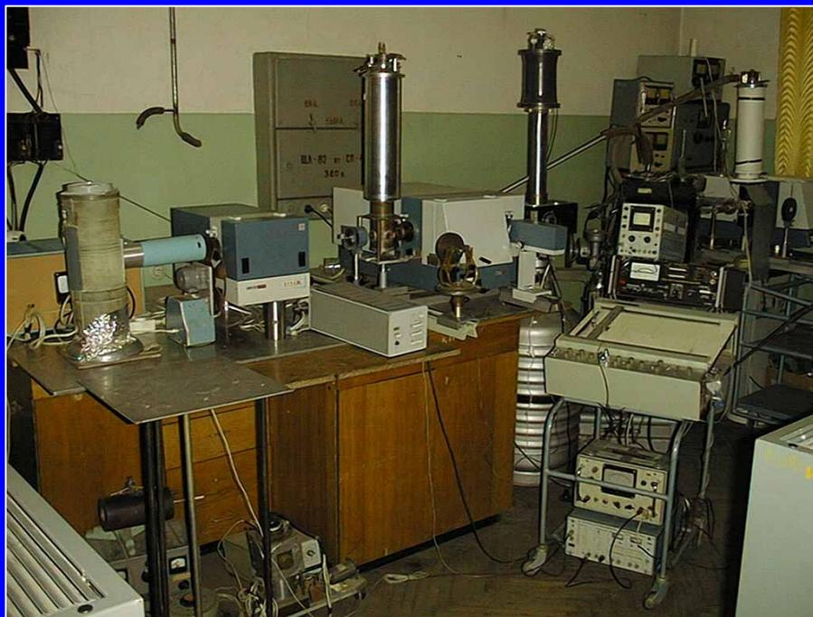
Высокочувствительный измерительный спектральный комплекс для контроля малых концентраций ( $10^{-6}$  ат.%) примесно-дефектных комплексов в алмазах позволяет проводить классификацию искусственных алмазов, определять область и диапазон их практического применения.
