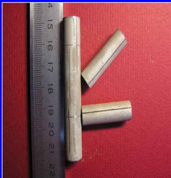
Предназначены для использования в составе сканирующих туннельных и силовых микроскопов. Поле сканирования при напряжении  $\pm 150$  в – (140x140) нм, чувствительность к изгибу – не менее 0,5 нм/в, внешний диаметр – 11,2 мм, внутренний диаметр – 9,8 мм, длина – до 70 мм. Форма электродов – по требованию заказчика. Поставлялись для предприятий: ЗАО “НЕТ” г.Москва, ИММС НАНБ г.Гомель, МГУ, ГГУ
