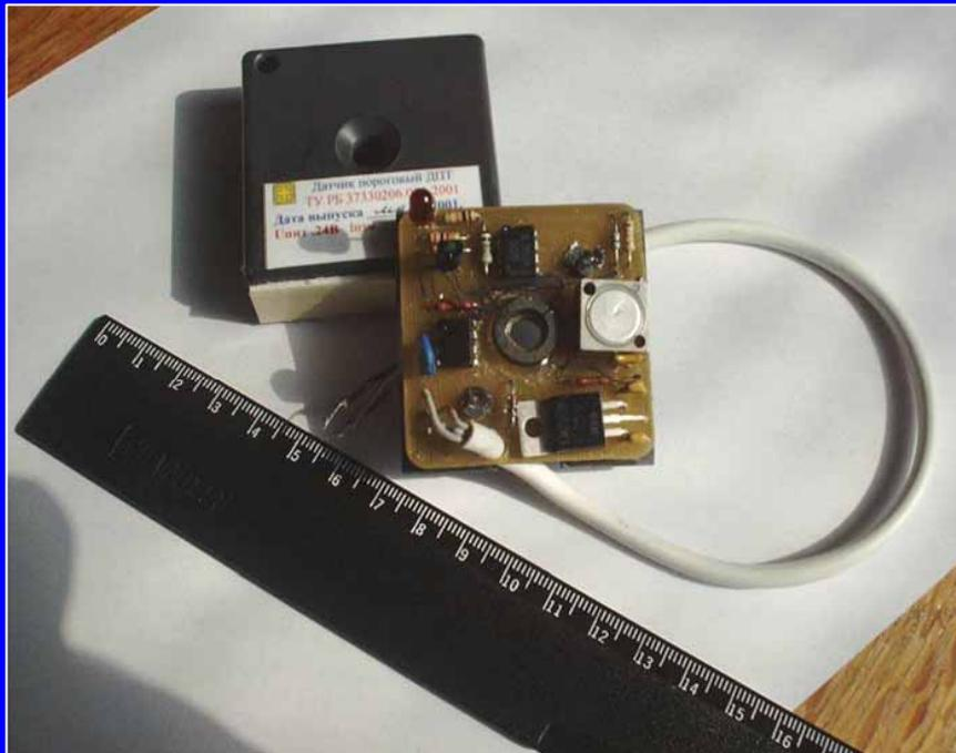
Предназначены для измерения постоянного тока в диапазонах от 10 мА до 50 А. Гальваническая развязка от токовой измерительной цепи и по выходу через оптопару.
