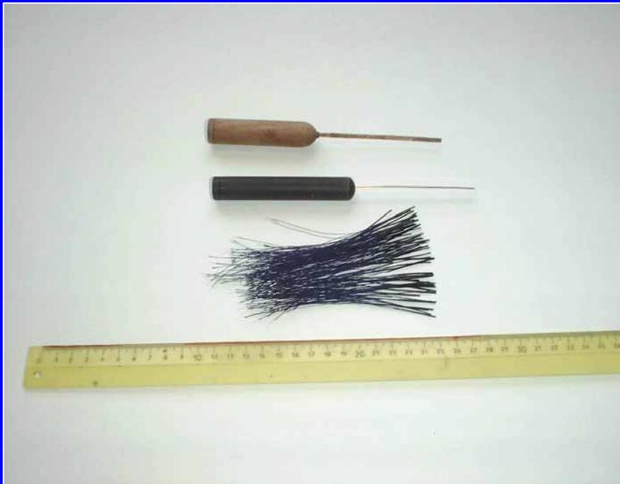
Магнитометрические зонды для измерения нормальной и тангенциальной составляющих магнитного поля, для измерения в тонких зазорах от 100 мкм, для криогенных измерений от 1.5К.
