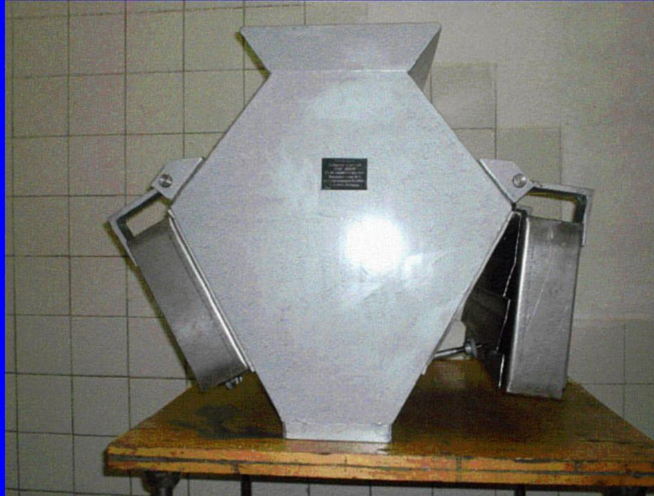
**Предназначены для извлечения металломагнитных примесей из потока зерна и продуктов его переработки, для предотвращения искрообразования**
