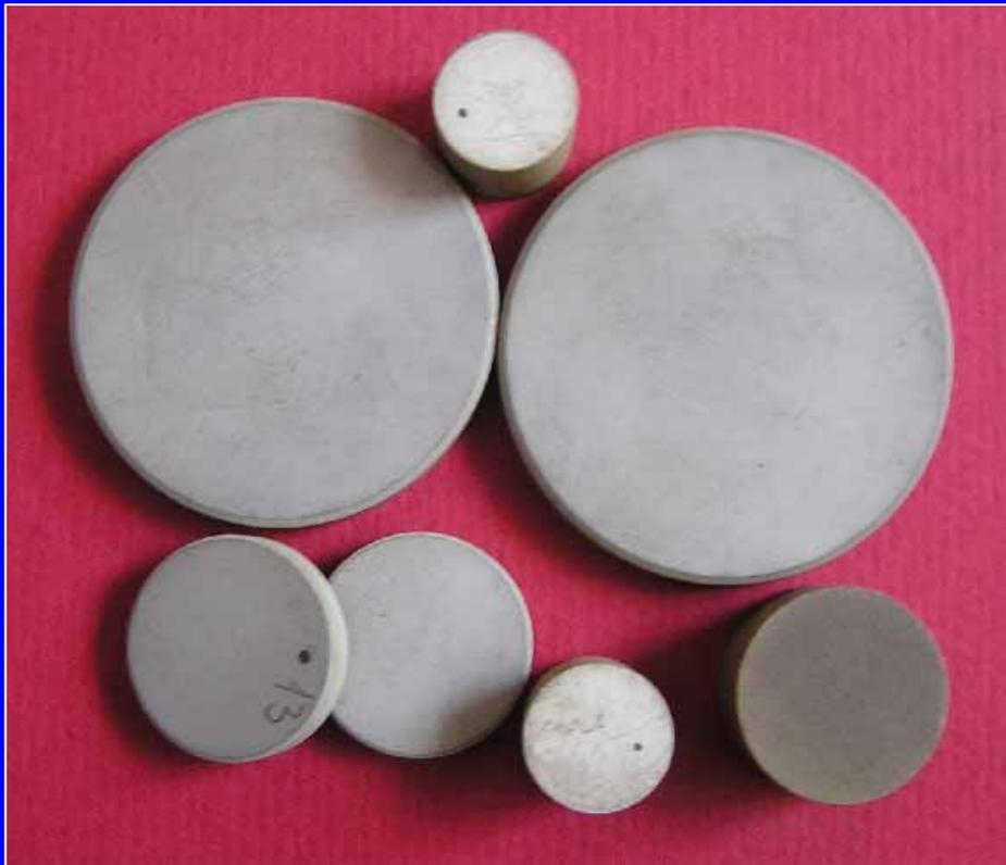
Керамический материал предназначен для производства энергоемких конденсаторов, предназначенных для изготовления накопителей электрической энергии. Обеспечивает удельную энергоемкость до 0,7 Дж/см<sup>3</sup>.
