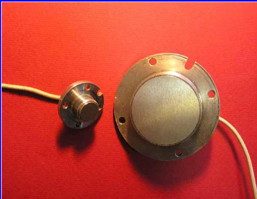
Предназначены для работы в составе первичного преобразователя для объемного измерения воды, пара, нефтепродуктов, пищевых продуктов. Рабочая частота: 0,5; 1,0; 2,0; 4,0 МГц. Рабочая температура измеряемой жидкости -  $(+2 \div 250)^{\circ}\text{C}$ . Коэффициент передачи напряжения от излучателя к приемнику через рабочую жидкость не менее 0,5. Поставлялись для предприятий: МПО "Вычислительной техники", НИИ ПФП БГУ, ПУП «Белсимет», завод "Измеритель"
