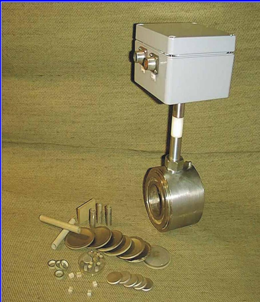
Предназначен для эксплуатации в составе комплекта теплосчетчика (расходомера) или для использования в других устройствах: диапазон рабочих температур измеряемой жидкости (5..130) °С; типо-размеры трубопровода: 25; 50 мм; конструктивное устройство:
