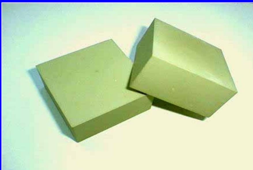
Диэлектрический материал предназначен для изготовления фильтров СВЧ - диапазона. Относительная диэлектрическая проницаемость – 86, добротность - 4000, ТКЧ в интервале температур (-60...+85) °С не больше 0,00001 ( $\Delta f/f \Delta T$ ). Поставлялись для предприятий: НПФ "Период", НПО "Комета" г. Москва, ПО "Гамма" г.Запорожье, ЗАО «Ритек-Корус», ЗАО «КБ НАВИС».
