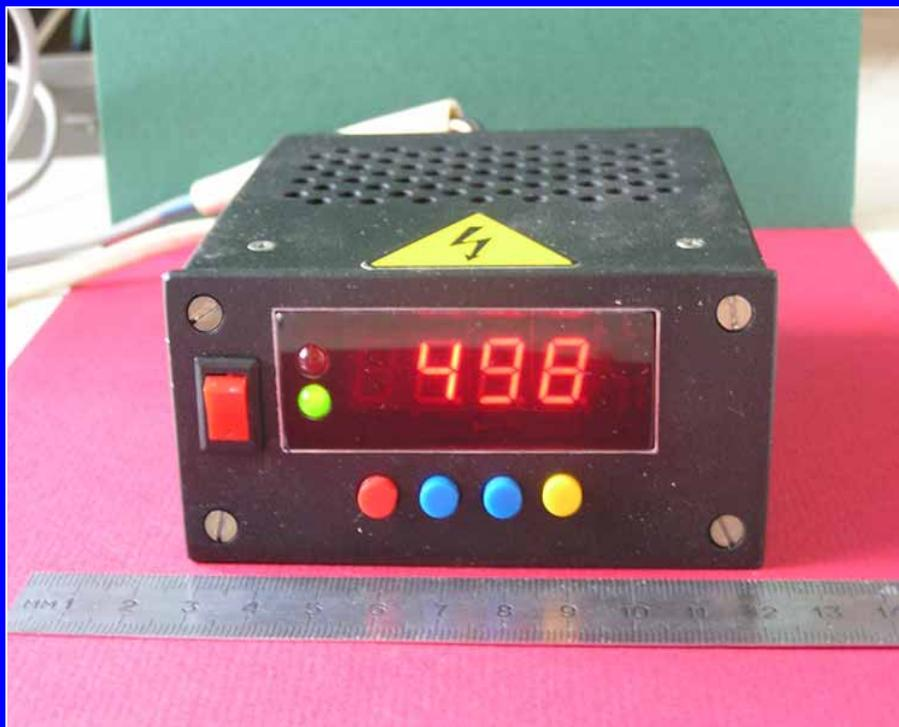
Одноканальный измеритель температуры с фронтальными размерами 96x48 мм предназначен для измерения температуры в промышленности и в научных исследованиях в лабораторных и цеховых условиях.
