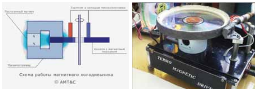
Рис. 3 Схема работы магнитного холодильника и экспериментальный образец термомагнитного двигателя
