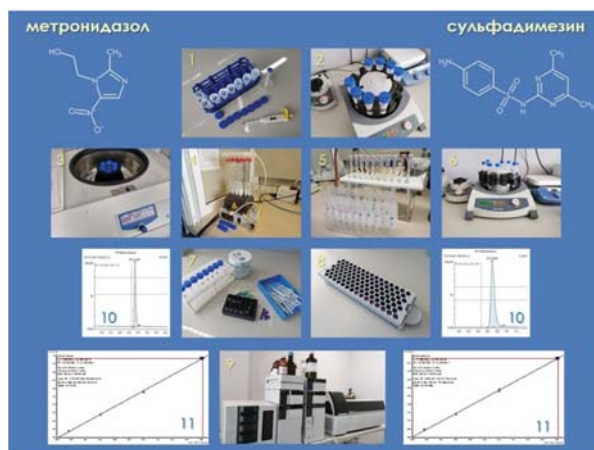
Рис. 32. Основные этапы определения массовой доли сульфадимезина и метронидазола в пищевой продукции животного происхождения
