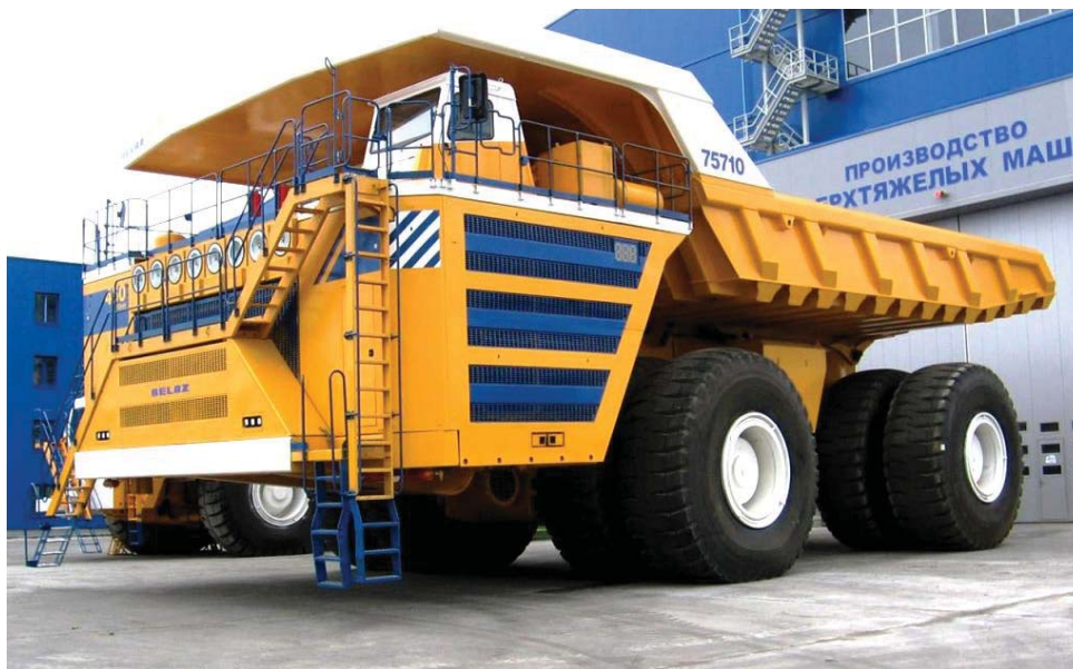
Рис. 76. Карьерный самосвал грузоподъемностью 450 т с электромеханической трансмиссией, колесной формулой 4×4
