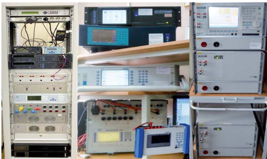
Рис. 93. Модернизированный национальный эталон единицы электрической мощности
