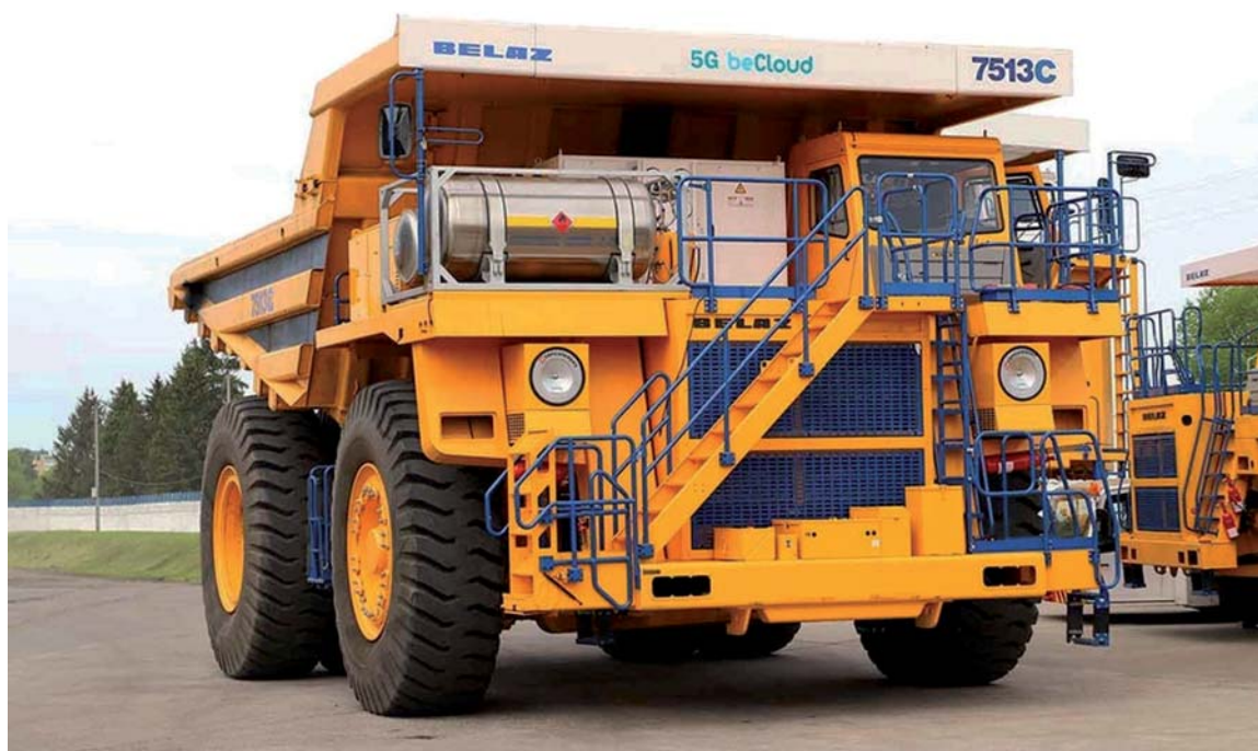
Рис. 78. Карьерный самосвал, использующий природный газ в качестве моторного топлива
