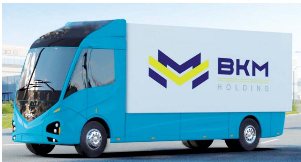
Рис. 77. Грузовой электромобиль грузоподъемностью до 10 т с подготовкой под установку системы беспилотного управления
