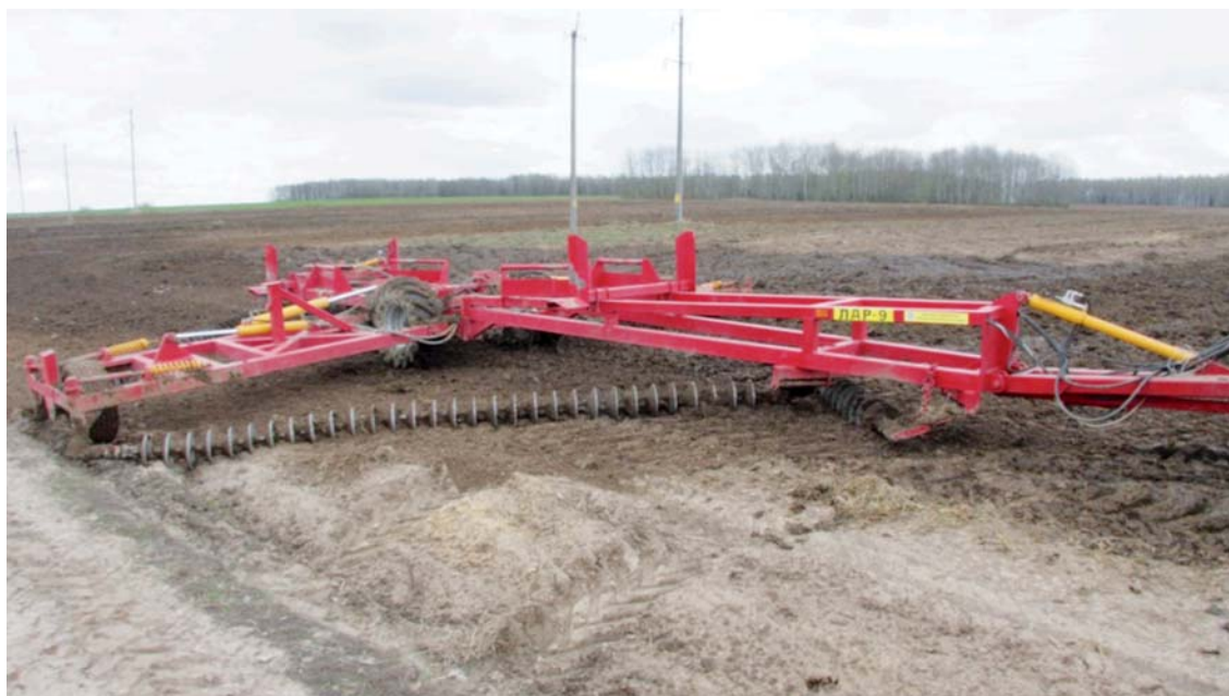
Рис. 115. Луцильник дисковый ромбовидный ЛДР-9
