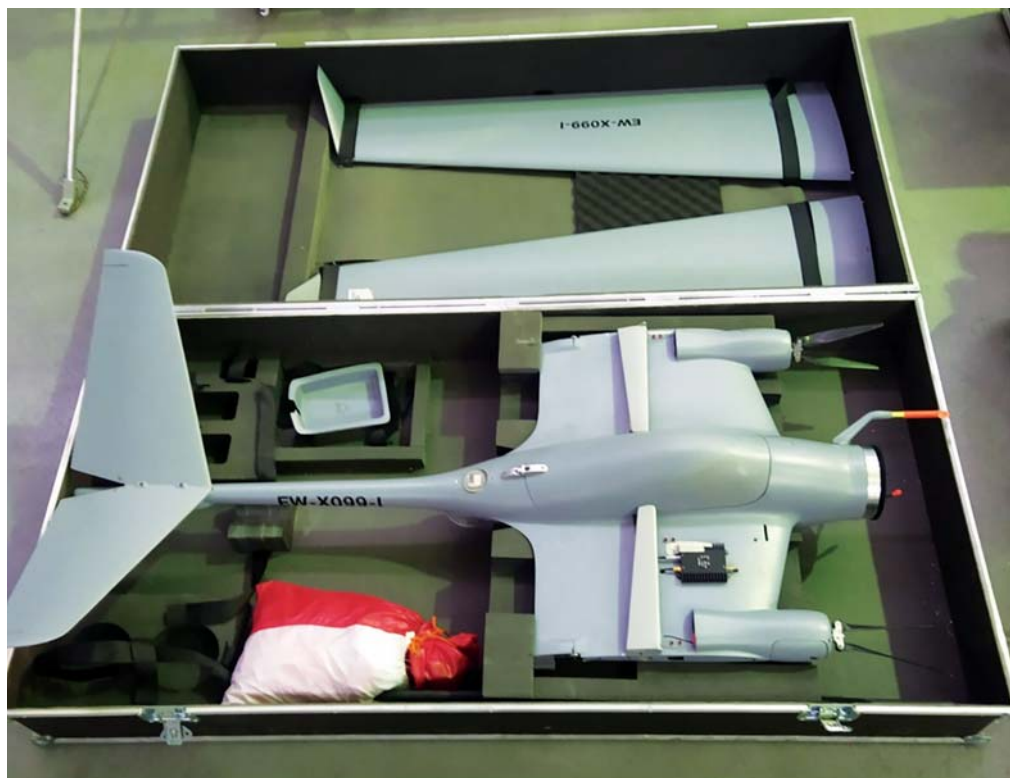
Рис. 7. Опытный образец многофункционального беспилотного авиационного комплекса (МБАК) «Бусел МБ» с дальностью применения до 70 км
