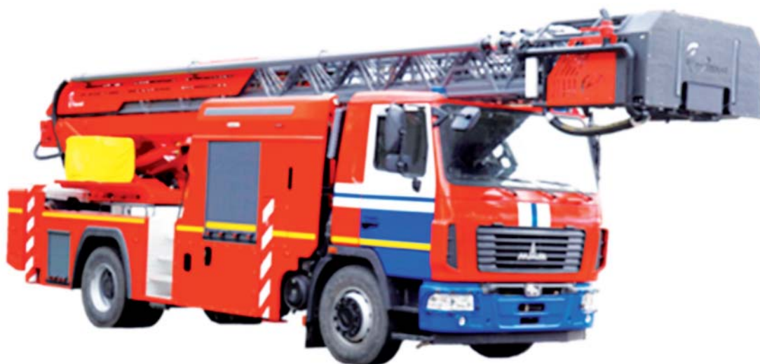
Рис. 118. Автолестница пожарная на базе шасси МАЗ с высотой подъема 32 м со съемной люлькой на вершине стрелы
