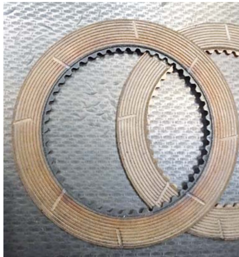
Рис. 84. Фрикционные диски с закаленным зубчатым профилем из фрикционного материала с заданными фрикционными свойствами
