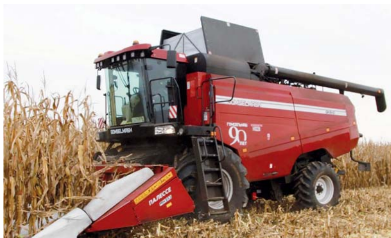
Рис. 79. Комбайн зерноуборочный самоходный расчетной производительностью 21 т/ч трех модификаций
