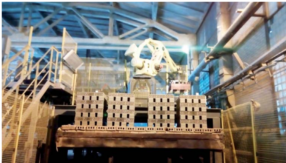
Рис. 86. Робот-садчик высушенных изделий поризованной керамики в ОАО «Обольский керамический завод»
