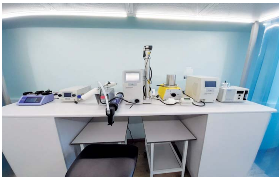
Рис. 90. Комплекс оборудования, предназначенный для генерирования, сбора, классификации, измерения размера и счетной концентрации частиц до 1 мкм
