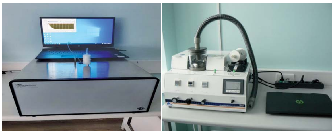
Рис. 89. Лазерный аэрозольный спектрометр и генератор монодисперсных аэрозолей
