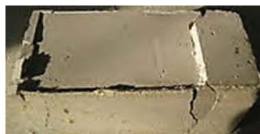
Рис. 7. Образец сухого гипсового камня ( \rho = 1175 \text{ кг/м}^3 ) с волокнами ТВН-2 (ИКТ) после испытаний на прочность
