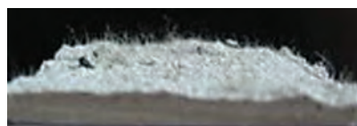
Рис. 8. Поверхность разрушения образца сухого гипсового камня ( \rho = 1175 \text{ кг/м}^3 ) с волокнами ТВН-2 (ИКТ)
