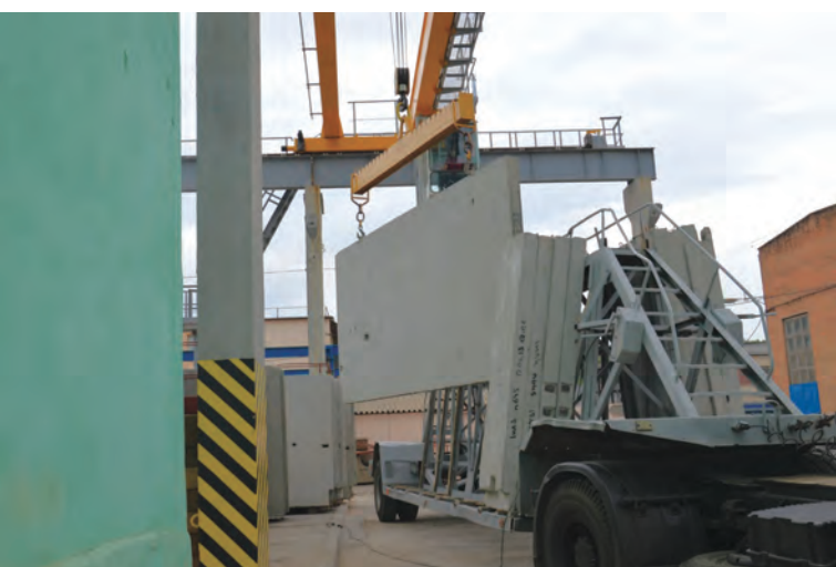
Рис. 5. Отправка панелей внутренних стен на объекты строительства
