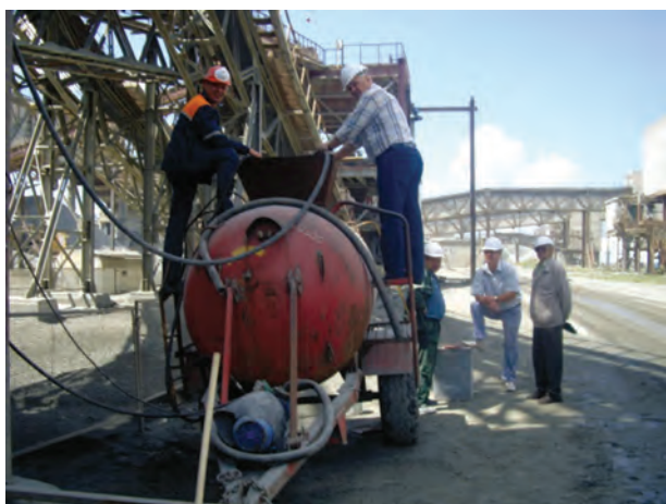
Рис. 4. Передвижная установка по активации щебня
