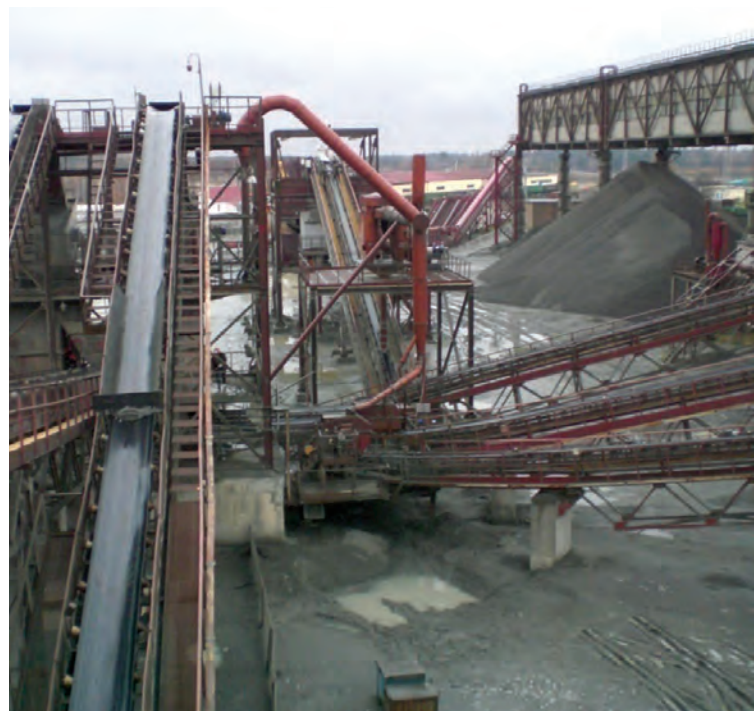
Рис. 2. Технологическая линия по разделению щебня на фракции
