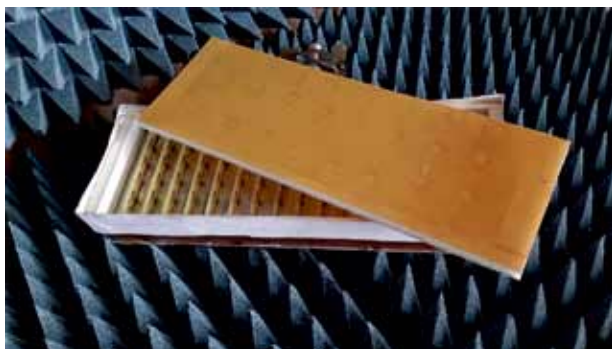
Рис. 7. Экспериментальные образцы подрешеток совместно с плоскими экранами
